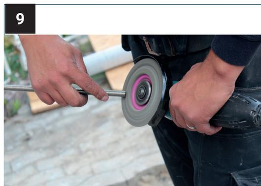
Entgranten Sie die Schnittstellen der Gewindestange mit der Schleifmaschine.
