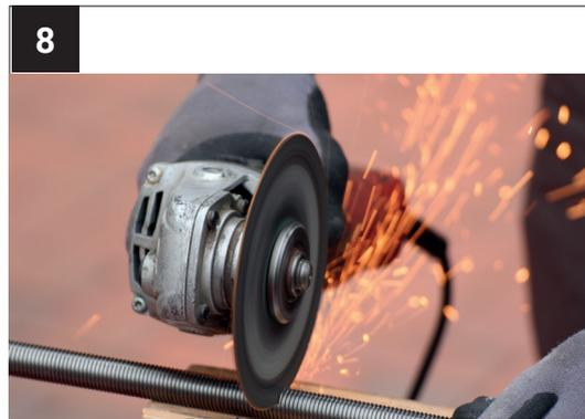
Schneiden Sie die Gewindestangen auf die benötigte Länge zu. Sie sollte ca. 3 cm länger als die Siebhülse sein.
