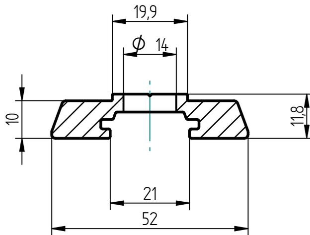
Bohrung  $\phi 14$  alle 150mm
