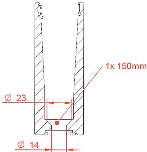
In das Klemmprofil - aus Aluminium EN AW 6063T5 - mit der Bezeichnung BOFS-8553, Einzellänge  $\leq 6000$  mm, werden VSG-Scheiben aus 2 x 8 mm ESG aus Float / 1,52 mm PVB mittels Kunststoffkeilen mit der Bezeichnung 1.7.010.30 eingeklemmt und auf Glasauflagen mit der Bezeichnung 1.7.010.20 aufgelagert. Weitere Details enthält [1].
