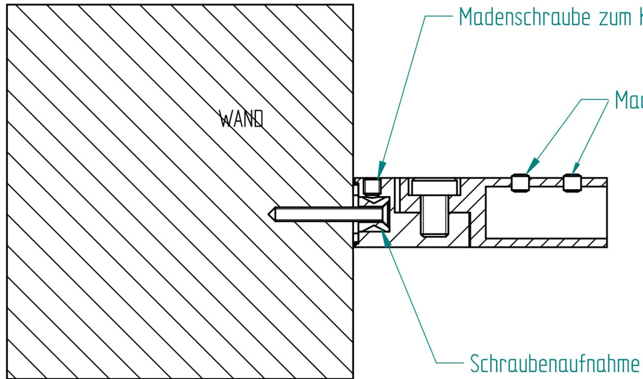
Madenschraube zum Klemmen der Schraubenaufnahme
