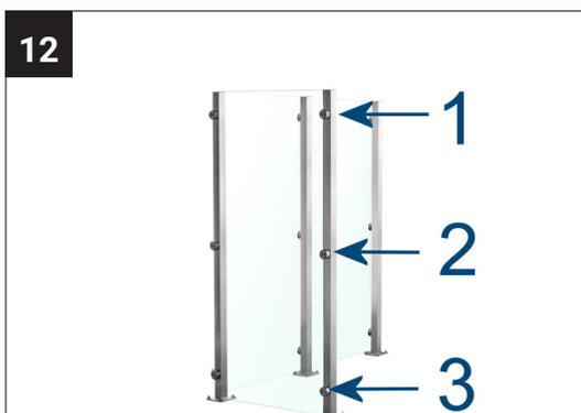
Richten Sie die Glaskante oben entsprechend Ihrer technischen Zeichnung aus. Schrauben Sie nun das Glas von oben nach unten arbeitend an den Glashaltern fest.
