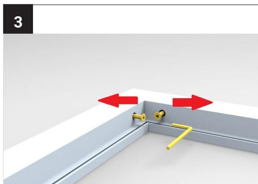
Schrauben Sie zuerst ein Seitenteil und die Kopfzarge locker zusammen. Wechseln Sie beim Festschrauben zwischen Seitenteil und Kopfzarge hin und her, damit sich die Zargenteile formschlüssig verbinden.
