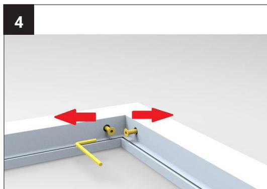
Schrauben Sie nun das andere Seitenteil an die Kopfzarge. Arbeiten Sie auch hier abwechselnd schraubend.
