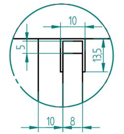
Da die Dusche auf eine Duschtasse kommt, werden 10mm eingezogen, um nicht auf dem Radius der Duschtasse zu montieren!
