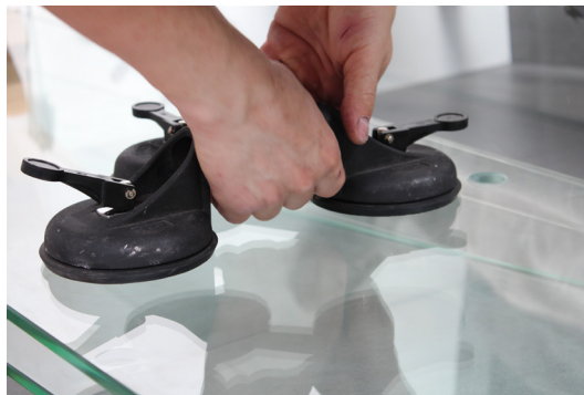
Einsatz eines Glassaugers
