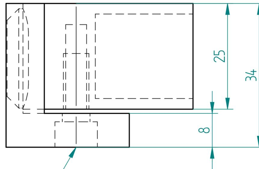
Zylinderschraube zum verbinden der Einzelteile
